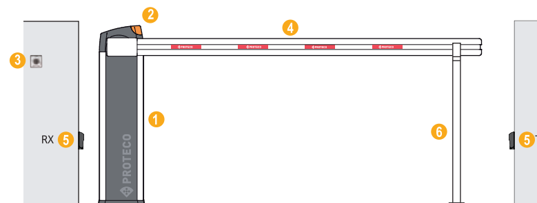
1_Barrera integrada con cuadro de maniobra y receptor radio 2_Lámpara de señalización 3_Seletores de llave 4_Asta en aluminio 5_Fotocélulas en cierre 6_Apoyo fijo
