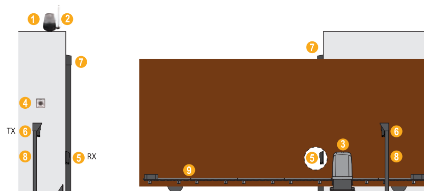
1_Lámpara de señalización 2_Antena exterior 3_Accionador integrado con cuadro de maniobra y receptor 4_Selector de llave 5_Fotocélula exterior 6_Fotocélula interior 7_Banda de seguridad 8_Apoyo fijo para fotocélulas 9_Cremallera
