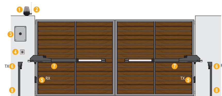
1_Lámpara de señalización 2_Antena exterior 3_Cuadro de maniobra 4_Selector de llave 5_Fotocélula exterior 6_Fotocélula interior 7_Motores 8_Apoyo fijo para fotocélulas
